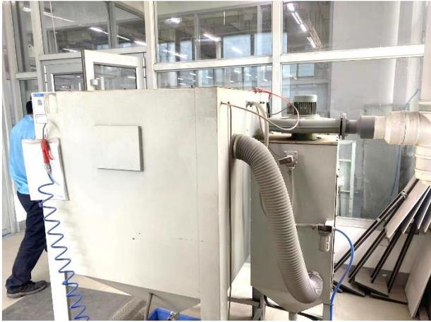
喷砂机自带除尘器
