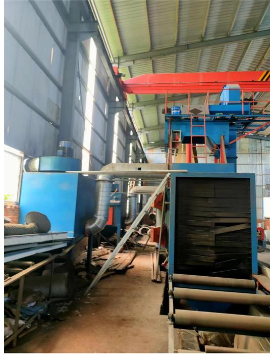
抛丸工序旋风除尘+滤筒除尘+15米排气筒
